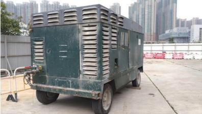
空氣壓縮機主要用於在鑽土過程從樁孔中移除挖掘物料，方法為利用空氣壓縮抬起挖掘物料
