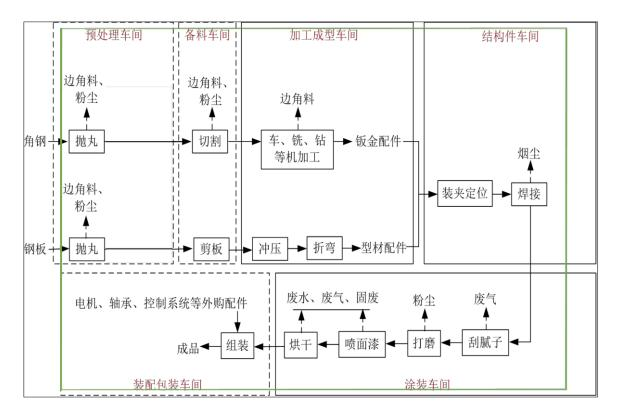
①抛丸工序:将外购的钢板及角钢在预处理车间进行抛丸处理,提高工件表面的粗糙度,也提高工件后续喷漆的漆膜附着力。
