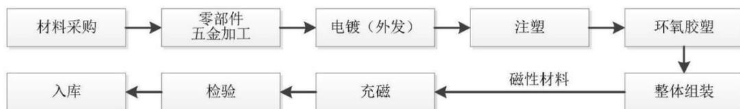
公司采购各种稀土磁性材料，如钕铁硼、铁氧体等组成磁源，根据客户需求进行表面处理，可以选择镀锌，镀镍，镀铬，喷漆或者橡胶覆盖等方式。
