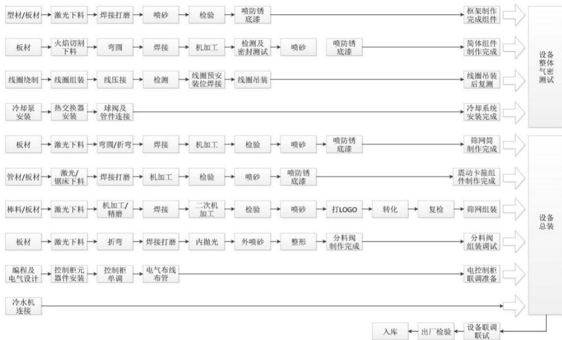
公司采购特制励磁线圈，在通电过程中产生强磁场，组成磁源；采购相关钢材，经过激光切割、焊接打磨、机加工以及喷砂等形成框架、筒体和筛网，最后将线圈、框架、筒体和筛网焊接组装在一起，并安装外购的控制柜，形成电磁除铁设备。
