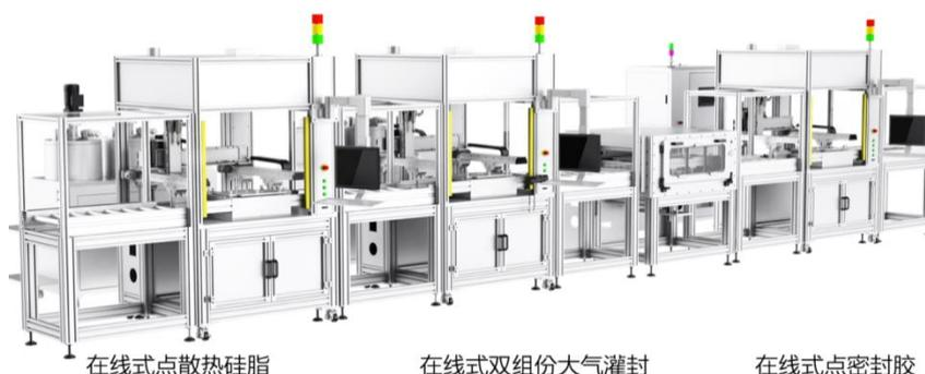
图 新能源真空灌胶生产线
