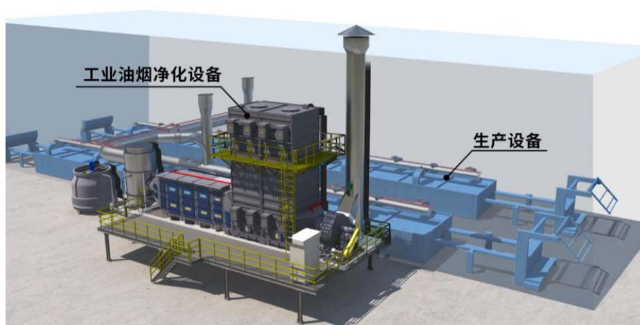
工业油烟净化设备安装示意图
