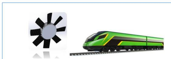
公司自主研发冷却风扇碳纤维叶轮成功上线，此款产品配套复兴号内燃机车和 160 公里动力集中内燃动车组，在不增加功率的情况下，风量比设计值提升 10.5%，效率提升 9%，叶片重量降低 50%，具有高效、低噪、重量轻优势。
