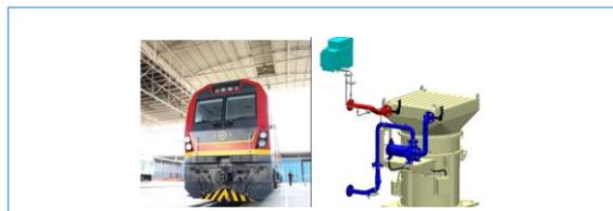
公司自主研发的配套于复兴号内燃机车专用的“小体积、大散热功率和高散热效率的变流器冷却塔”研发成功，并实现装车上线。
