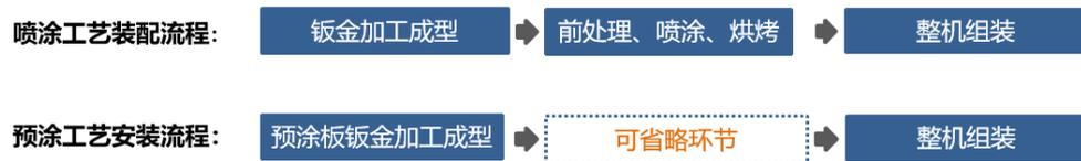
预涂工艺与喷涂工艺相比，家电外观复合板通过辊涂工艺完成复合膜或有机涂料的涂覆后，家电生产商可以将其直接加工成型做成各种部件或产品，对于家电制造厂而言省去了喷涂环节的工作，节省了投资和材料及半成品仓储运输费用。目前使用预涂装工艺的处理速度比喷涂线要快10倍以上，节能1/6-1/5，可降低下游家电厂商的生产成本5-10个点。
