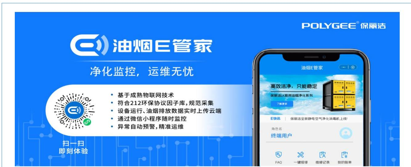
2020年初,公司上线了油烟E管家系统,该系统基于成熟物联网技术,符合212环保协议因子库,规范采集净化设备运行数据,实时上传云端,分析设备运行状态,有利于更高效的为客户提供运维服务。
