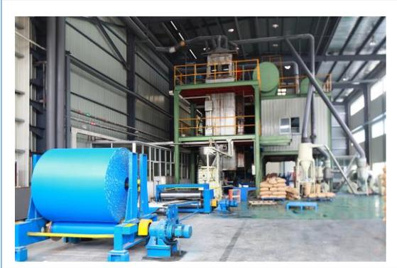
2019年5月，公司PVC整芯提升带生产线技改项目，生产线采用全自动化生产模式，生产效率提升30%，一次成型合格率
