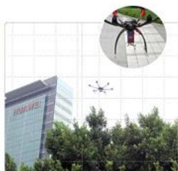
利用无人机进行3D MIMO信道模型测试
