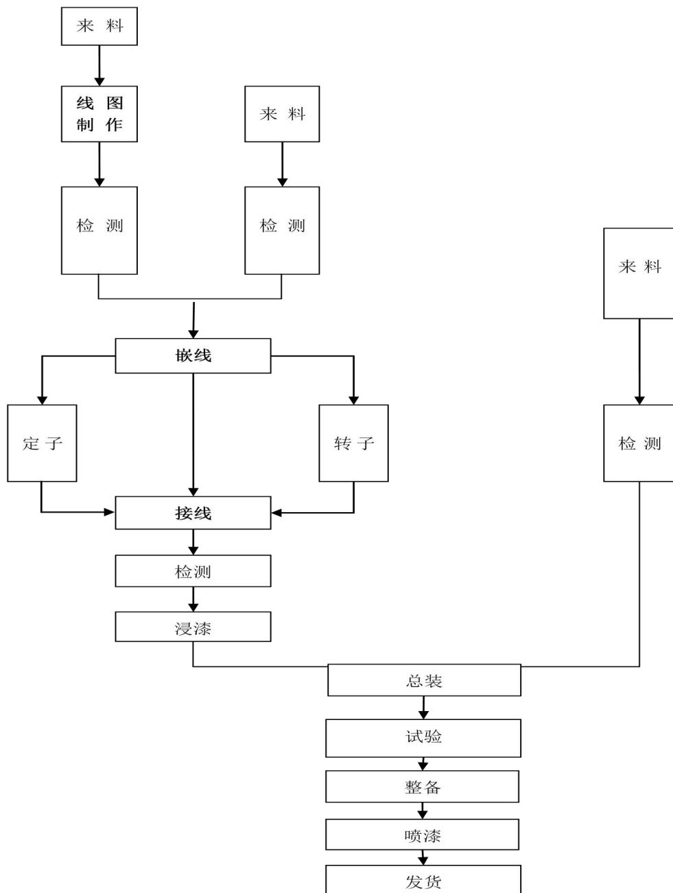
2) 2.0MW直驱风力发电机生产流程图:
