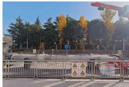
排水车水泵试验台
