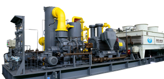
生物质气体增压液化机组
