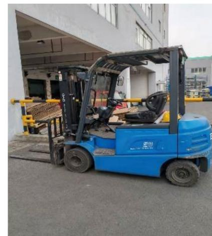
格力博常州制造基地通过更换电动叉车，以实际行动践行绿色环保理念。公司用12台电动叉车替代传统柴油叉车后，每年可节约约33.4万元的运营成本，同时减少了温室气体排放。以每台叉车每天运行6小时、年工作200天计算，电动叉车每小时仅需消耗6度电，而柴油叉车每小时需燃烧4升柴油。通过这一绿色升级，公司每年减少燃油消耗约33,600升。
