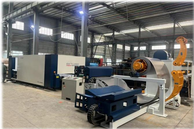
激光加工柔性生产线
