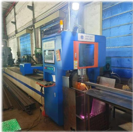
2024年，公司的三维激光切管机设备投产后，槽钢、角钢、扁钢等型材由原来的砂轮切割、模具冲孔等传统工艺改成激光三维切割，极大地节省了工件加工时间，提升生产效率，同时高精度的激光切割工艺提高了加工精度，确保产品一致性。
