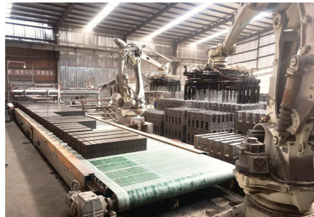
鄂尔多斯第 5.5 代 TFT-LCD 生产线利用回收污泥制砖
