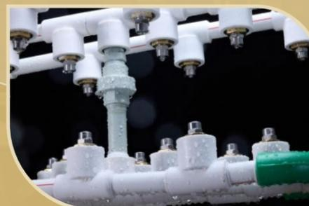
双管路改为三管路平等排列，管路上交错分布安装不锈钢伞型喷嘴，组成喷雾过滤装置
