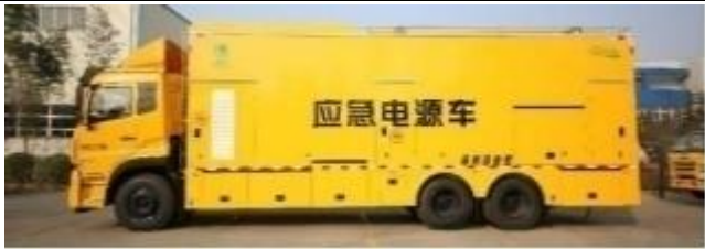
混合 UPS 不间断电源车
