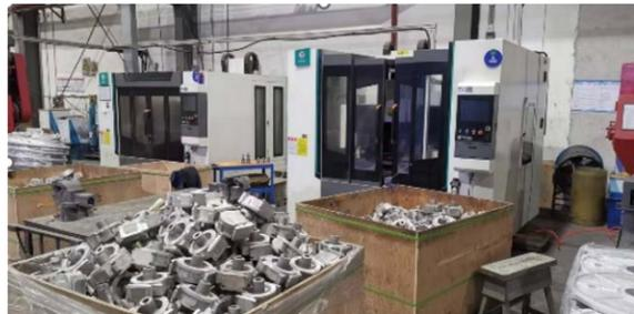
铝合金铸造车间的铸件切浇冒口和修除飞边毛刺由纯手工工改为 CNC 编程处理
