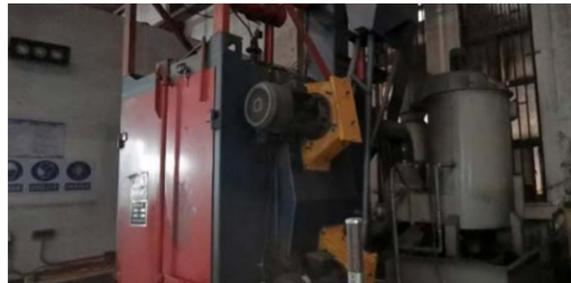
铝制零件抛丸机改装粉尘水处理设备，消除爆燃隐患
