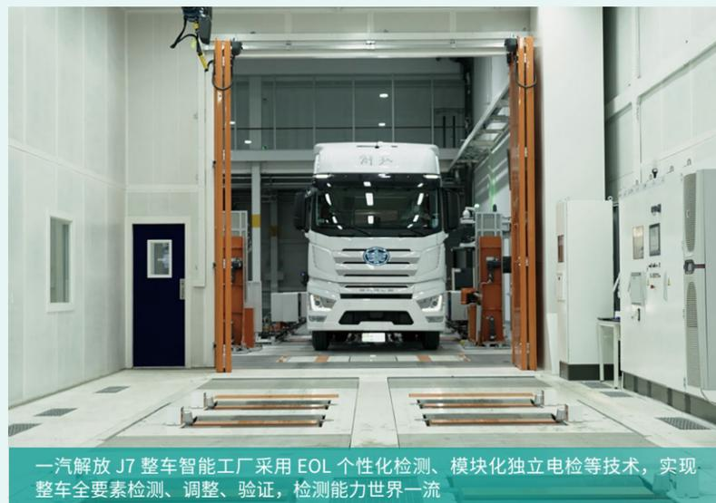
一汽解放 J7 整车智能工厂采用 EOL 个性化检测、模块化独立电检等技术，实现整车全要素检测、调整、验证，检测能力世界一流
