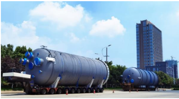
名称: HDPE 装置-第一、第二、第三反应器 规格: DN5000*15700 材料: Q345R 重量: 136T
