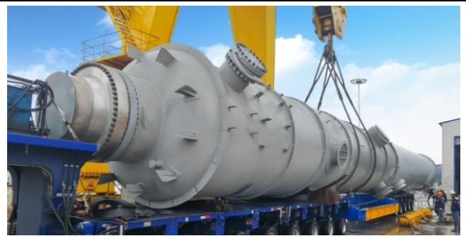
名称: 神华宁煤合成装置-循环气换热器 规格: DN3400*60*38745 F=5535m 2 材料: 15CrMoR/15CrMoR/S30403 重量: 280T
