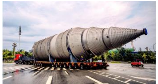
名称: HDPE 装置-粉料处理罐 规格: DN7000*32540 材料: S22253 重量: 161T
