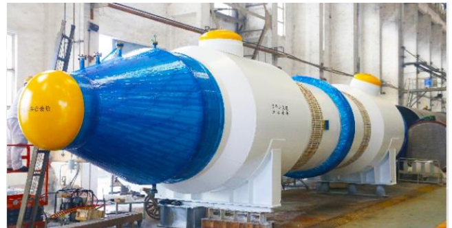
名称: 低压反应水冷却器 (深孔焊) 规格: DN2500*24*16473 材料: Q345R/S30403/TA2+S30403III 重量: 147.8T
