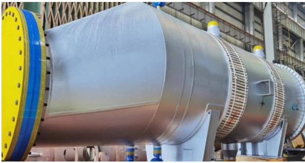
名称: 乙烯装置-裂解气二级急冷换热器 (深孔焊专利结构) 规格: DN1850*8836.5 F=420.6m 2 材料: 12Cr2Mo1R/15CrMo 重量: 77T
