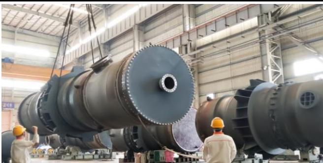
名称: 顺酐装置-切换冷却器 规格: DN2845*85*12614 F=4020m 2 材料: 13MnNiMoR/S31603 重量: 187T
