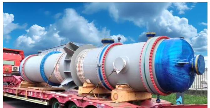
名称: 尿素装置-中压分解器 规格: DN1900*32*11652 材料: S25073 重量: 65.75T
