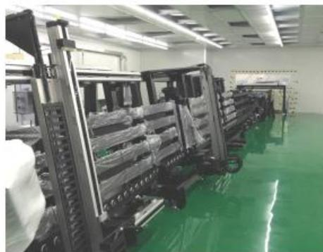
液晶玻璃基板检测系统
