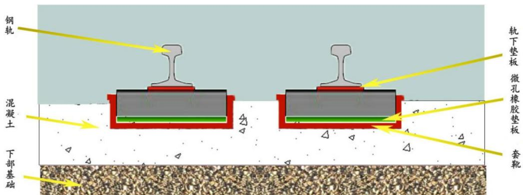
弹性支承式无砟轨道用橡胶套靴采用耐老化性能较好的橡胶、高品质炭黑和多种助剂制成，在承载能力、耐油性能和尺寸配合方面具有优势。套靴和微孔橡胶垫图示如下：
