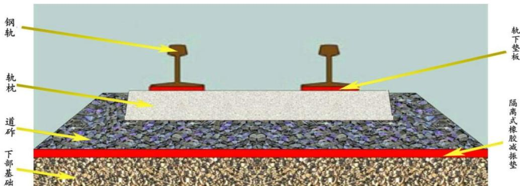
隔离式橡胶减振垫用于无砟轨道时，通过满铺或条铺的方式增加轨道合理的弹性和阻尼来吸收部分振动能量，从而达到减小道床应力、延长结构寿命、降低列车运行对沿线噪声敏感目标干扰的影响、满足环境影响评估的要求等目的。
