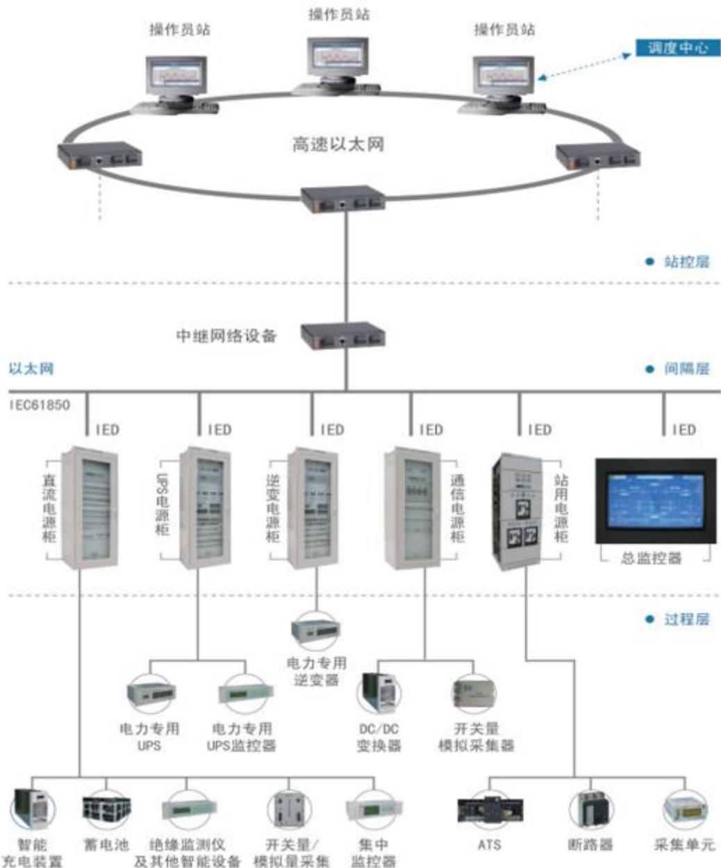
2023 年新产品电力用直流守护电源系统全面进入市场销售，已在国内部分省市交付并运行。传统的电力用直流电源设备，其接线方式是以蓄电池组安全可靠为基础。新型的电力用直流守护电源系统是在保持传统的电力用直流电源设备主接线方式和运行模式不变的前提下，通过引入蓄电池分组管理技术和充电装置高、低电压穿越技术，大大提高了直流母线的供电可靠性和电力用直流电源设备的智能化管
