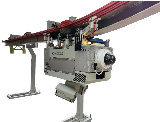
图 38、极寒轨道式智能巡检机器人
