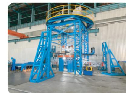
放射性污染混凝土烟囱内表面去污及内部工艺排气管拆除装置
