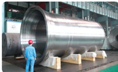
全球最大规格 DN3000 球墨铸铁管管模
