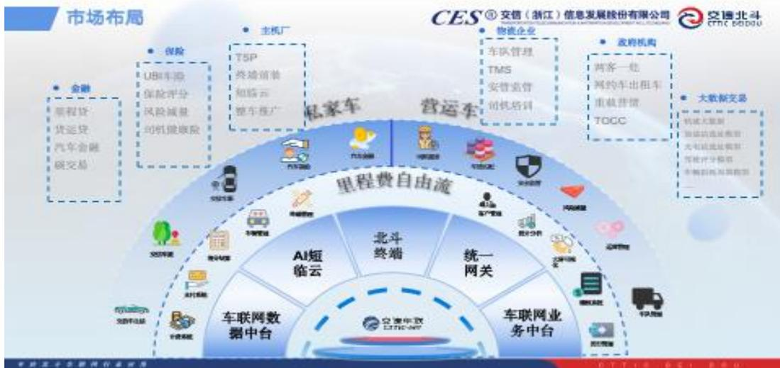
1、北斗自由流里程费业务，是通过融合北斗高精度定位、路径识别、云计算、5G/4G 互联网、大数据等多种技术，在不增加大量基础设施建设运维成本的前提下，实现车辆“自由通行，无感计费”。产品应用是通过规模化部署车载北斗智能终端，搭建北斗自由流收费与动态监控云服务平台，实现无收费站模式下车辆高效快速通行与精准计费，提升“一脚油门踩到底”的通行体验，并拓展基于北斗位置数据采集的监测预警、通信指挥、应急服务、金融保险、数据运营、双碳管理等增值应用，助力智慧交通建设。基于“用路者付费”原则，运用北斗自由流收费技术，按照车辆实际行驶里程采用不同道路功能与等级、车辆类型与排放水平的差异化费率，精确计量支付的道路使用。未来业务主要通过北斗技术实现里程费用收取以及金融服务来获得持续利润，可以从里程费运营服务、保险服务、银行购买（补贴）终端、加油导流服务、停车运营服务、北斗交通双碳管理服务等方面获取收益。2023 年，海南道路附加费项目在重点路段实施模拟测试。
