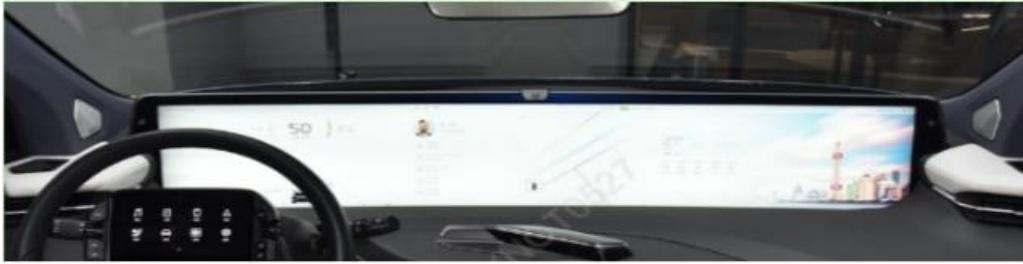
公司汽车电子客户包括日系、欧系、美系、德系品牌车商，覆盖了全球 70%以上的车辆品牌。近年来，公司推出的以搭载 3D 曲面车载盖板的车载屏模组业务有助于汽车终端座舱具有更好的一体化显示效果，通过热压成型，将平面玻璃加工成 V、C、S、L、U、W 等不同形态的曲面玻璃，并通过曲面印刷技术制造成完整的车载 3D 盖板，3D 盖板尺寸能达到 1.6 米×0.6 米，最小曲率半径  $R < 30$ 。公司以卓越的创新能力和深厚技术储备不断满足客户异形定制需求，提升用户体验，现已完成“车载 Sensor+车载触控模组+车载盖板+车载触显一体化模组”的产业链布局。定位于高端显示制造领域，其厂房、产线、设备等空间布局具有一贯性，并按照行业最新先进水平搭建，配备了自动化水平更高、精度更优、尺寸跨度更大的设备，具有自动化程度高和低成本优势。以上技术优势、产业链布局优势、产线优势得到客户认可，促进公司车载触显模组全贴合产品出货量放量增长，现已在国际、国内车载客户供应链体系中占据重要地位。
