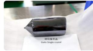
韶关冶炼厂利用自有技术成功制备出第一根砷化镓单晶棒，初步判定为零缺陷长单晶体，砷化镓单晶装备、晶体生长工艺控制等方面技术已达国内同行业领先水平。
