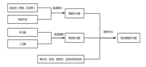
聚酯多元醇由多元醇和二元酸高温缩聚而成,具有较高的硬度,良好的附着力,在聚氨酯合成中充当柔性软链段的角色,而异氰酸酯与小分子扩链剂构成聚氨酯的硬链段部分。本公司主要生产芳香族聚酯多元醇,由于分子中含有苯环刚性基团,可增加制品强度、耐热性、阻燃性等特点,一般用于制造硬质聚氨酯泡沫塑料,其中高羟值的聚酯多元醇基硬质泡沫,其阻燃性优于聚醚多元醇基泡沫塑料。
