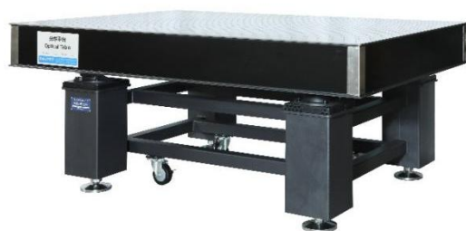
图. 典型隔振光学平台
