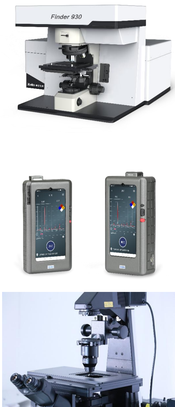
图. 典型各型拉曼光谱仪（台式共焦和手持式）
