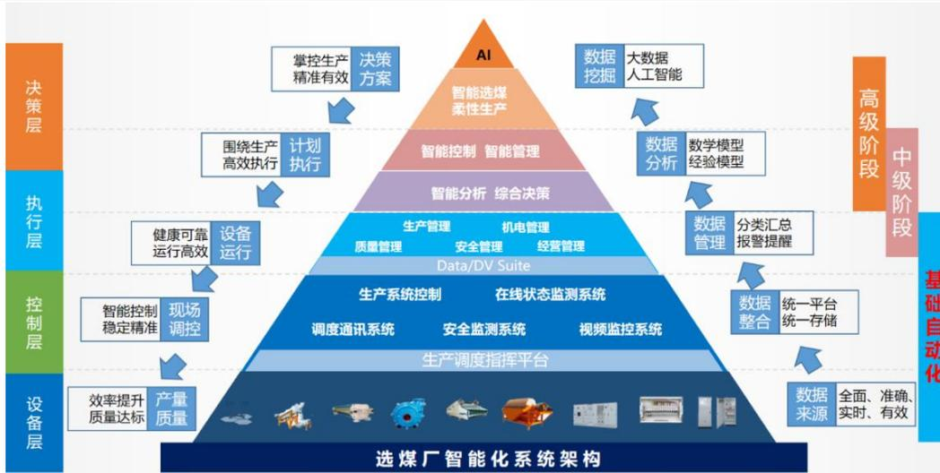
图 22：选煤厂智能化系统架构
