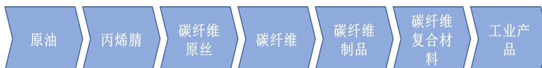
碳纤维制备流程：PAN 基原丝通过放丝装置恒张力均匀的依次通过各级预氧化炉、低温碳化炉、高温碳化炉、表面处理及水洗，然后依次进入热辊干燥、上浆、热风干燥、热辊干燥进入卷绕机收丝，最后经过自动包装线包装为成品碳纤维。其中，预氧化炉为热风循环炉，纤维在预氧化炉内空气氛围下发生氧化反应，形成耐热梯形结构。低温碳化炉和高温碳化炉为电加热炉，纤维在低温碳化炉和高温碳化炉内氮气氛围下发生反应，脱除非碳元素。碳丝制备流程中涉及的主要设备包括放纱架、预氧化炉组、低温碳化炉、高温碳化炉、表面处理浴池、
