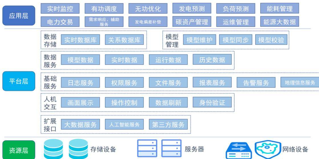
微电网及虚拟电厂综合能源管理平台从下而上分为资源层、平台层和应用层。资源层用于存储、计算、网络等硬件资源的管理与维护；平台层提供包括实时数据库、关系数据库等数据存储管理服务，模型数据、实时数据、运行数据、历史数据等数据服务，模型维护、模型同步、模型校验等模型管理服务，日志服务、权限服务、文件服务、报表服务、告警服务、地理信息服务等基础服务，画面展示、操作控制、数据刷新、身份验证等人机交互服务，提供扩展接口，能够接入人工智能服务、第三方服务等；在资源层和平台层的支撑下，应用层可以提供实时监控、有功调度、无功优化、发电预测、负荷预测、电力交易、能耗管理等应用；通过对基础应用的综合使用和进一步整合，平台可实现微电网及虚拟电厂功能，帮助用户对负荷侧资源进行深度管理和综合利用。
