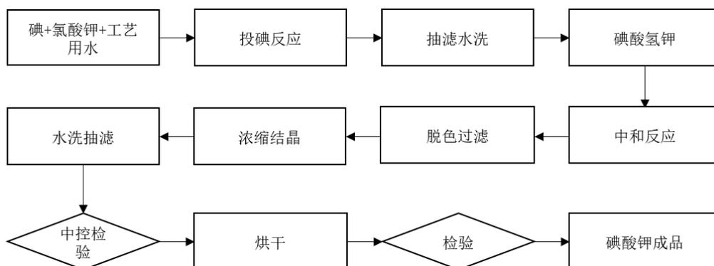
碘酸钾产品在投碘反应工序采用“高纯碘酸钾生产工艺”核心技术。使用效果详见本节“六、发行人的技术及研发情况”之“（一）发行人核心技术”。
