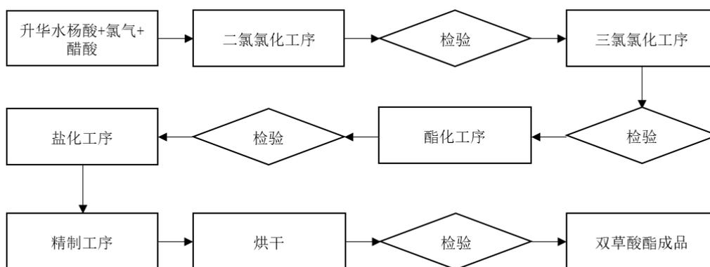
双草酸酯产品在二氯化工序、三氯化工序、酯化工序等工序采用“双草酸酯合成工艺”核心技术。使用效果详见本节“六、发行人的技术及研发情况”之“（一）发行人核心技术”。
