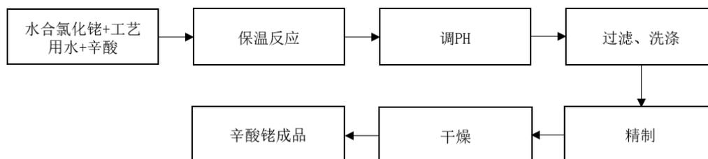
辛酸铑产品在保温反应等工序采用“辛酸铑合成工艺”核心技术。使用效果详见本节“六、发行人的技术及研发情况”之“（一）发行人核心技术”。
