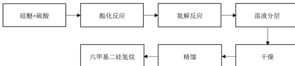
六甲基二硅氮烷产品在酯化反应、氨解反应等工序采用“六甲基二硅氮烷生产工艺”核心技术。使用效果详见本节“六、发行人的技术及研发情况”之“（一）发行人核心技术”。
