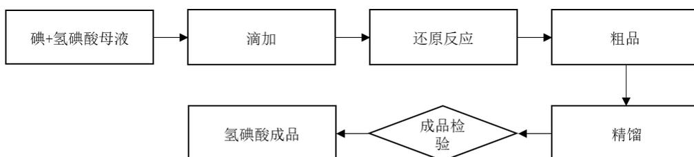
氢碘酸产品在滴加、还原反应等工序采用“亚磷酸法生产氢碘酸工艺”核心技术。使用效果详见本节“六、发行人的技术及研发情况”之“（一）发行人核心技术”。
