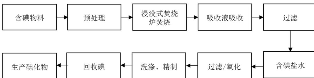
碘回收方面在预处理、浸没式焚烧炉焚烧等工序采用“浸没式焚烧法回收碘工艺”核心技术。使用效果详见本节“六、发行人的技术及研发情况”之“（一）发行人核心技术”。
