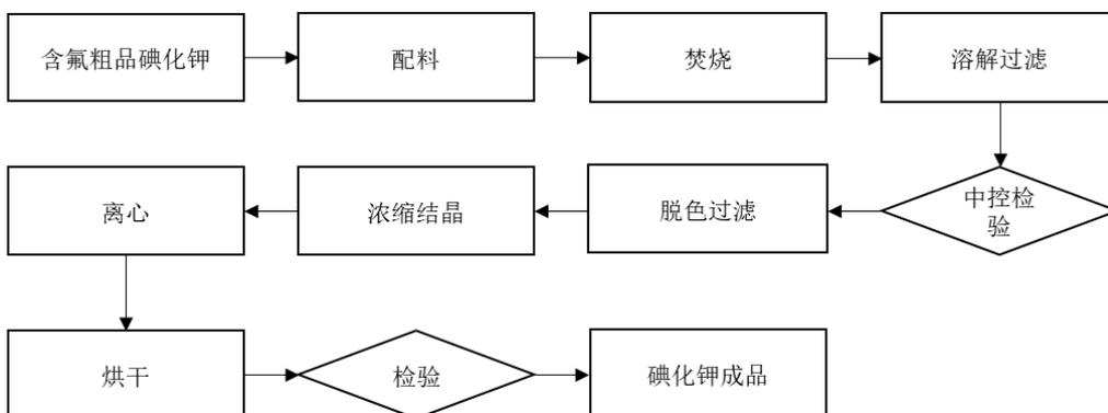
此流程下生产的碘化钾产品在配料、焚烧、溶解过滤等工序采用“表面防护剂类含碘废料的综合利用”核心技术。使用效果详见本节“六、发行人的技术及研发情况”之“（一）发行人核心技术”。
