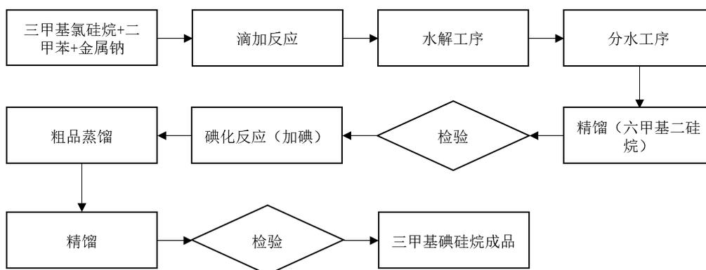
三甲基碘硅烷产品在初始投料工序采用“溶解加碘制备三甲基碘硅烷”核心技术，滴加反应、水解工序、分水工序等工序采用“三甲基碘硅烷的制备方法”核心技术。使用效果详见本节“六、发行人的技术及研发情况”之“（一）发行人核心技术”。
