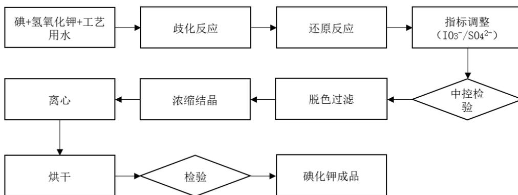
此流程下生产的碘化钾产品在还原工序采用“高纯碘化钾生产工艺”核心技术。使用效果详见本节“六、发行人的技术及研发情况”之“（一）发行人核心技术”。
