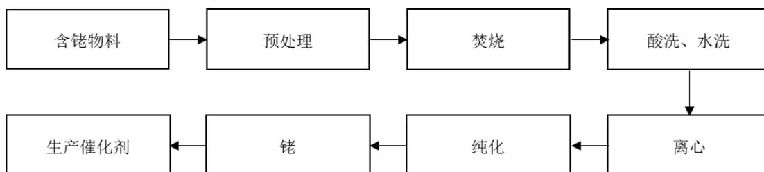
铈回收方面在焚烧工序采用“辛酸铈废催化剂循环利用工艺改进”“低浓度含铈有机废液回收铈工艺研究”核心技术。使用效果详见本节“六、发行人的技术及研发情况”之“（一）发行人核心技术”。
