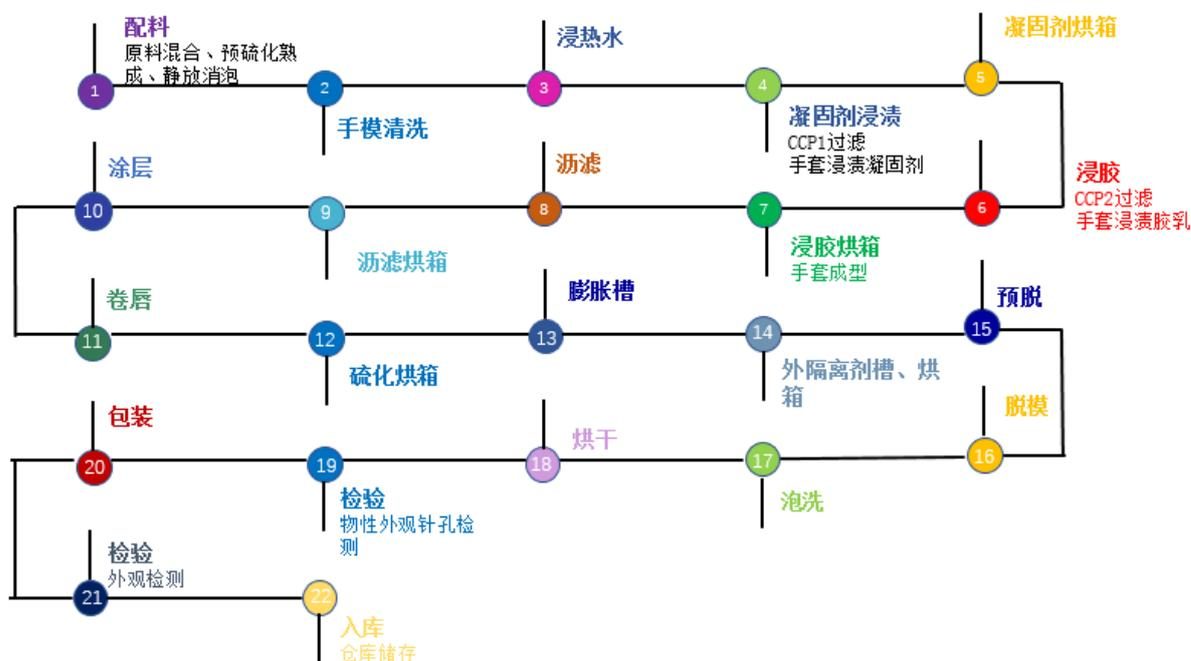
一次性乳胶手套生产的主要工艺流程为：手模浸渍凝固剂进入烘箱进行干燥，之后进行胶乳浸渍，经胶乳烘箱使手套成型，经沥滤清洗表面杂质进入烘箱烘干表面水分后沾涂层，经自动卷唇系统、硫化、进入膨胀槽，再经过外隔离剂烘箱后进行预脱，通过自动脱模机进行全脱，脱模且手套烘干后进行包装。手模经过清洗后再次浸渍凝固剂进行循环生产。
