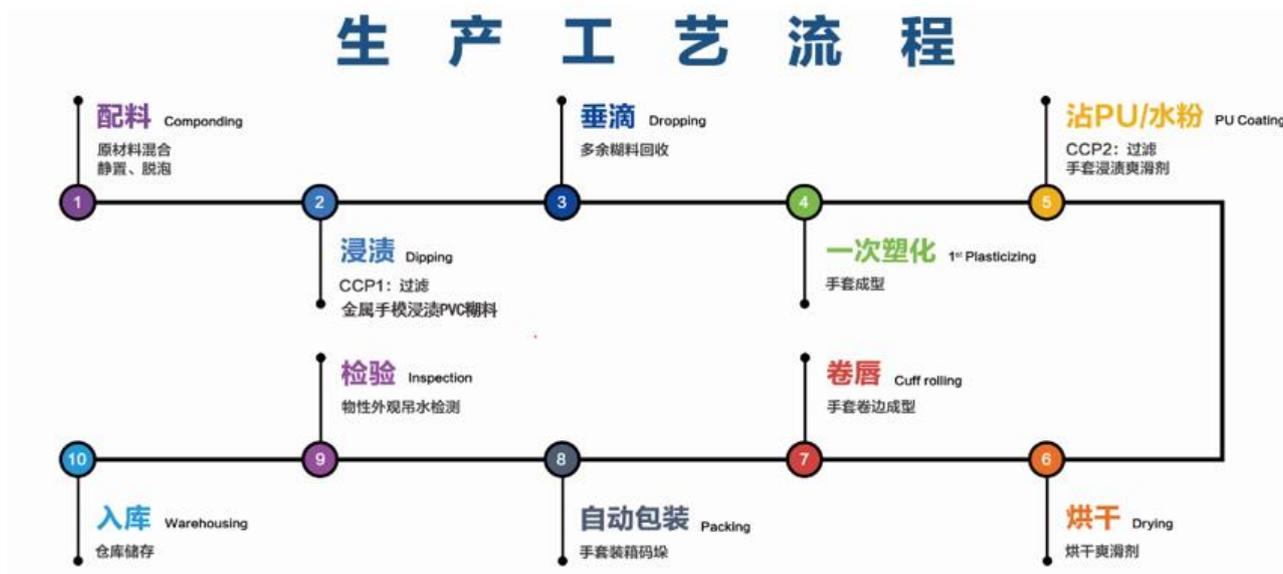
一次性PVC手套生产的主要工艺流程为：金属手模浸渍PVC糊料经垂滴后进行塑化，降温冷却后浸渍PU或水性玉米淀粉，干燥后进行卷唇，经预脱、自动脱模机后，分拣出缺陷品后进行码沓包装。之后用毛巾等擦拭手模余料，干净的手模再次浸渍PVC糊料进行循环生产。
