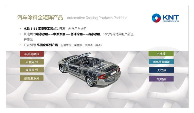
阴极电泳涂料与汽车面漆统称为汽车原厂涂料,一般是指涂装在汽车等各类车辆车身及零部件上的涂料,由于其综合性能要求(包括外观指标、机械性能、防腐性能、耐候性能、施工配套性等)高于其他涂料种类,且必须与科学的涂装工艺紧密配套,其研制、生产和施工难度水平高,因此汽车原厂涂料是工业涂料最重要的细分门类之一。标准的汽车车身涂装结构由电泳涂层与面漆构成,传统的面漆工艺由中涂涂层、色漆涂层与清漆涂层构成,目前主流的免中涂B1B2面漆工艺则由色漆涂层与清漆涂层构成。从底层的电泳涂层——中涂涂层——色漆涂层——清漆涂层,公司均有对应的产品进行覆盖。
