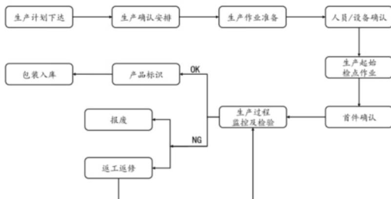
公司建立了完善的生产管理制度，对产品生产工艺及生产流程实行责任管理。在具体生产过程中，公司实行严格的生产管理，在割料加工、磨削加工、车削加工、热处理加工、精磨加工、无损探伤、外观检测、清洗防锈、包装入库等各个工艺环节严格按照生产工艺流程作业，各工序责任落实到人，保证产品质量。
