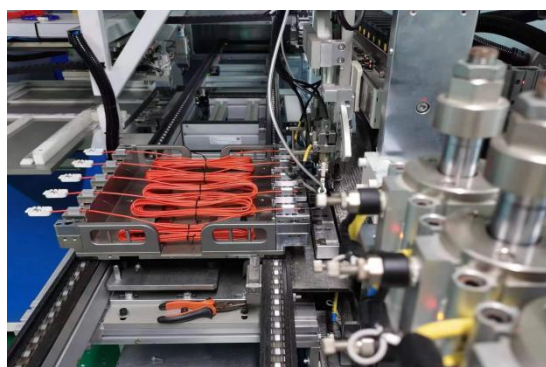
图九 工业电子雷管自动化生产线
