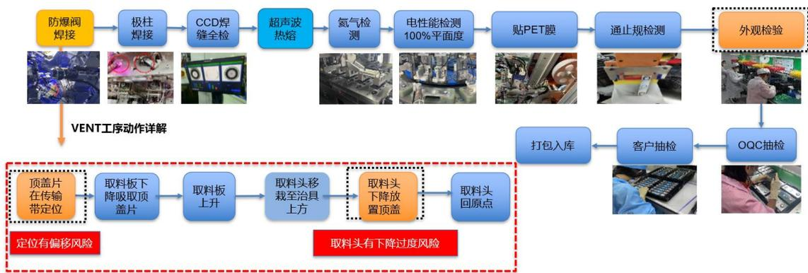
公司经全过程排查及失效件金属丝形貌确认，锁定金属丝的产生原因，并相应进行整改。具体原因分类如下：
