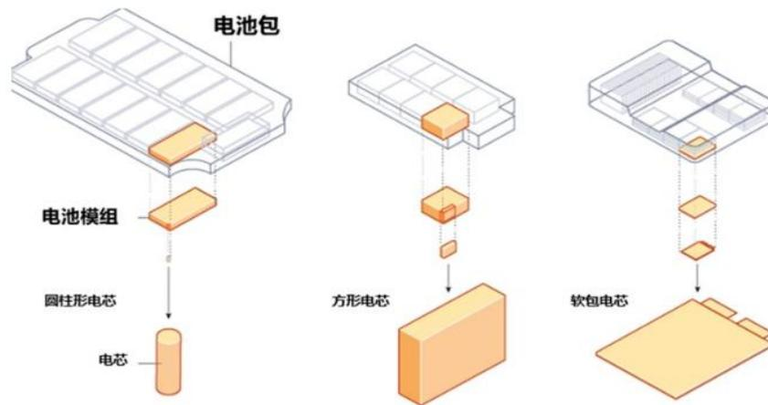
锂电池结构件顶盖和壳体组成动力锂电池电芯,是构成动力电池模组的最小单位;多个单体动力电池电芯在物理结构和电路上连接起来构成电池包的最小分组模组,可作为一个最小单元替换;多个电池模组的组合进而组成动力电池电芯包。目前电池结构件根据外形形态,主要分为方形、圆柱。方形包括拉伸方形电池结构件和滚压工艺刀片电池结构件,圆柱电池目前主流为21700电池,随着Tesla开发的4680系列电池量产,46系列有BMW等多家主机厂也和宁德时代和亿纬锂能签订了46系列的订单。
