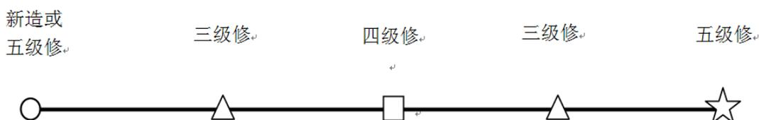
图3-10 动车组高级检修周期循环图
