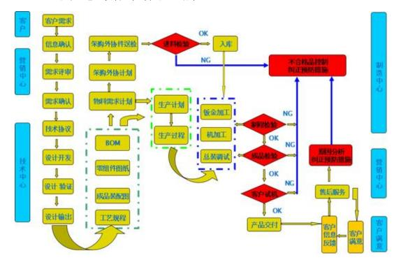
从以上流程可以看出,锂离子电池自动化生产设备为根据客户定制的非标产品,公司与客户签订订单前,双方需通过技术部门协商论证并确定设备整体方案,在与客户签订订单后,按照设计 BOM,由 PMC 部门分解出的采购计划、生产计划进行零配件的采购,设备的机械整合及自主开发软件系统的集成之后,将整机交付给客户。
