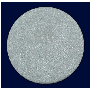
细化后晶粒形态（240 μm）
