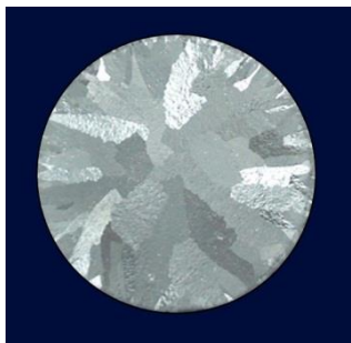
细化前晶粒形态（20mm）
