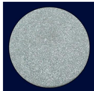
细化后晶粒形态 (240 μm)
