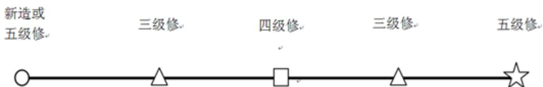
图 3-10 动车组高级检修周期循环图
