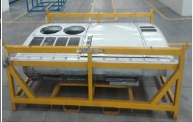
图 3-12 CRH1 平台动车组空调检修产品
