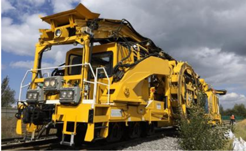
图 3-15 哈斯科 G04S-III-CN 型道岔清筛车
