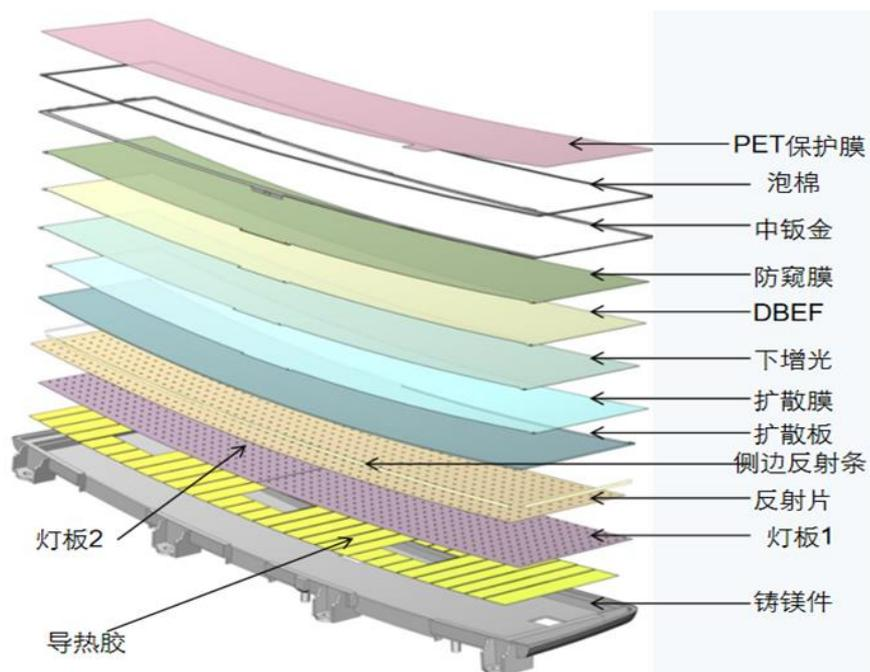
公司生产的侧入式 LED 背光源主要由铁框（胶铁一体、铸件）、导光板、FPC、LED、石墨片、扩散片、上下增光、遮光胶带等组成；生产的 Mini LED 背光源主要由铝板（铸件）、灯板（FPC 灯板、PCB 灯板、玻璃基灯板）、反射片、扩散板（扩散膜）、分光膜、增光膜、上铁框、泡棉等材料组成。
