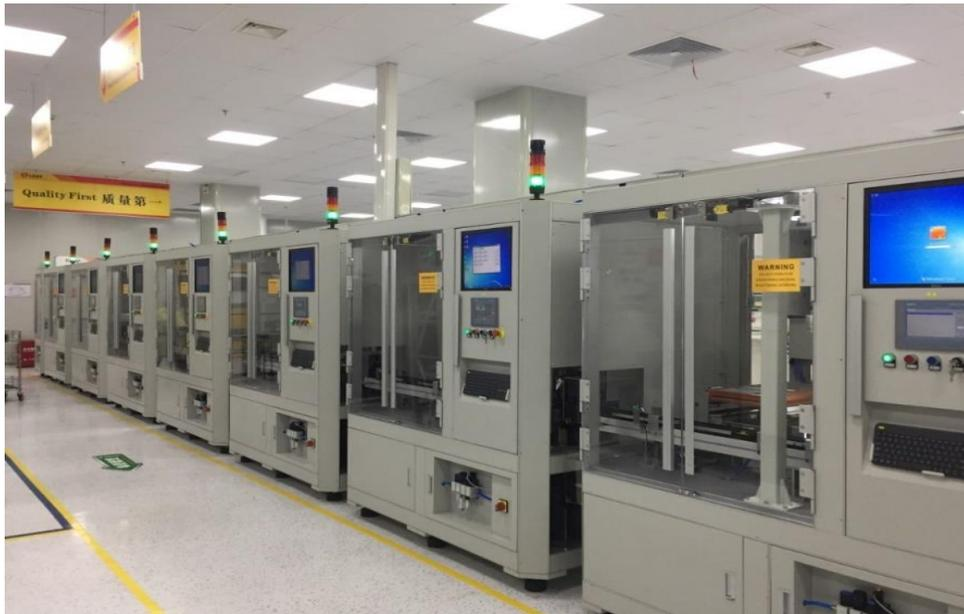
产品的柔性化、智能化和数字化，可满足下游客户柔性化的生产趋势，单机之间任意插入或删除单机，随意重组，互换性高，各单元采取网络化，总线控制。下游客户产品换型时只需更换互换性模块，产品换型成本低。产品设置数据采集层、分析执行层、数据存储层和管理存储层四个信息管理层，基于TCP/IP的网络通信，通过RFID射频采集模块和扫描采集模块，将生产数据上传至总控，一物一码，实现物料追溯、生产数据上传存储分析、ERP系统数据对接、生产信息实时监控等功能。
