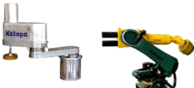
机器人配套本安型智能相机、智能振动声音传感模组等系列用于危险环境的智能感知及预测性维护等产品为专有技术；其中温度监控、ESD 及接地监控及碰撞保护等均已申请专利。公司研发的防爆关节机器人和本安型防爆示教编程器获经过验证，获得了防爆合格证书，解决了之前机器人产品无法在 F1 区、21 区等危险区域带电示教操作关键安全问题。该防爆关节机器人及其相关智能器件，广泛地应
