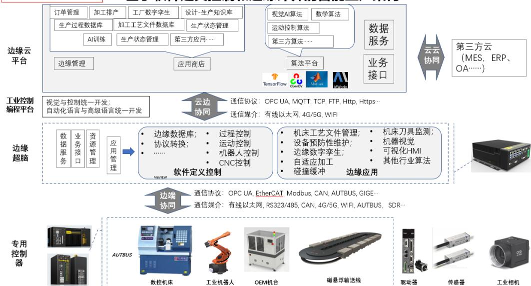
数字工厂智能控制解决方案项目将工业互联网“端、边、云”技术构架与工业制造领域相结合，设计并形成智能工业平台的系统架构，在此基础上开发平台各子系统。本项目将打造一个可以应用于多行业的边缘云平台，以支持接入工业生产线边缘侧设备，接入生产线的数据，并为云上的其他第三方应用业务提供数据访问接口，应用承载环境各子系统。各子系统既能协同运作，也能独立运行，既能保证系统的整体性，也可分阶段循序推进。
