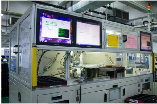
鼠标PCBA 按键功能与RF测试工艺
