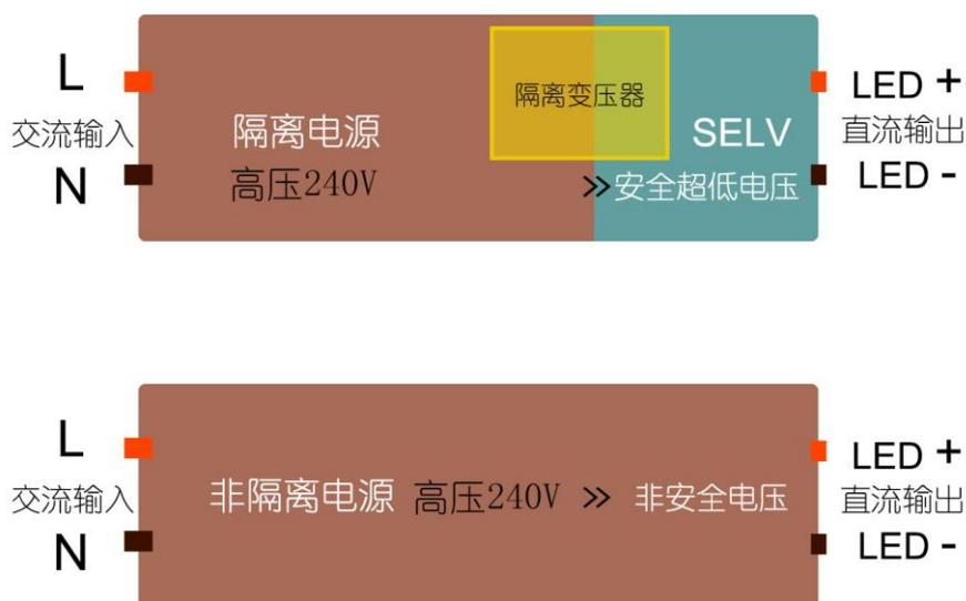
由上图可见，隔离电源、非隔离电源均是通过电气转换将交流电转换为直流电，而隔离电源经电子元器件转换后输出的是安全超低电压，而非隔离电源经电子元器件转换后输出的仍为非安全高压。
